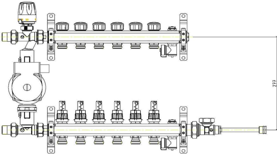
Монтаж смесительного узла в этом случае осуществляется путем замены поставляемых с коллектором стандартных кронштейнов на новые, поставляемые со смесительным узлом кронштейны с резиновыми уплотнениями.
