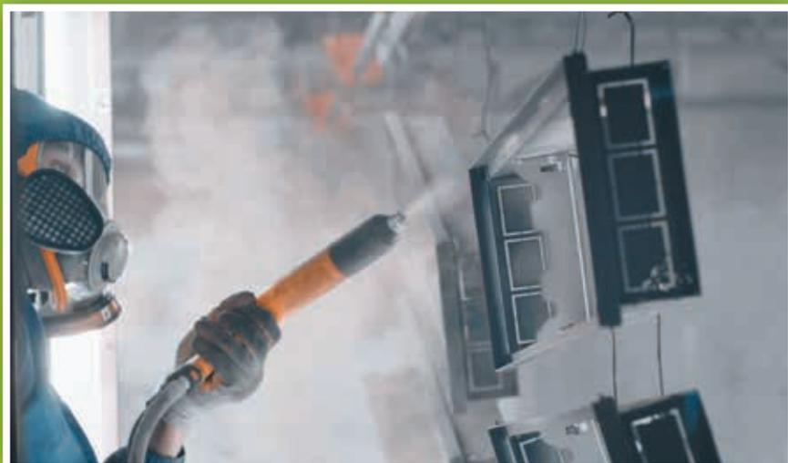
Монолитное и качественное покрытие поверхности изделия обусловлено равномерным способом напыления порошковой краски на всю поверхность конвектора. Гарантом высокой стойкости к коррозии является этап закрепления — каждый конвектор после окрашивания попадает в камеру полимеризации для запекания краски при 200 °С и придания ей эстетичного вида.
